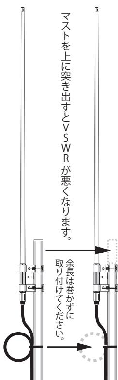
注) アンテナに金属製のマストなどを接近させると V.S.W.R. が悪くなります。アンテナ周囲の障害物から  $\lambda / 8$  以上離してください。
